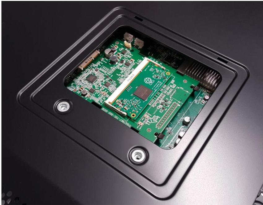
Raspberry Piを自社製品に組み込みたいと考える人も多くいます。これを手助けするために、「Compute Module」を作りました。これは小型のSO-DIMM PCBにRaspberry Piを搭載したもので、メインPCBのソケットにはめ込みます。
